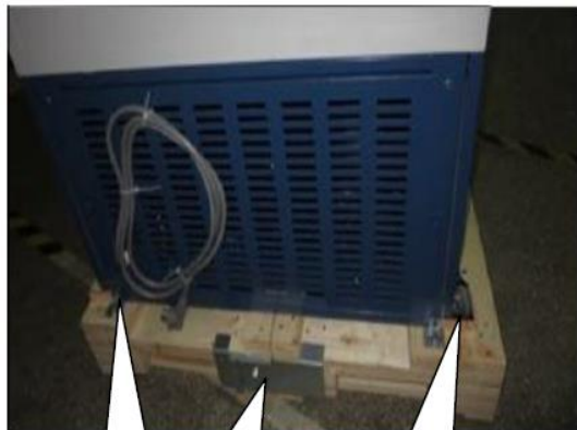
固定螺钉 A Fixed bolt A 固定螺栓 B Fixed bolt B 固定螺钉 A Fixed bolt A
